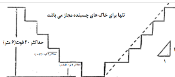
شکل ۳۴: گودبرداری های شیب دار چند پله ای
