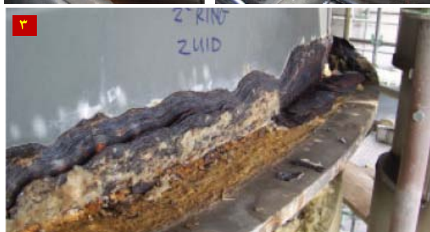
(۱) و (۲) - نمونه هایی از عایق آسیب دیده
