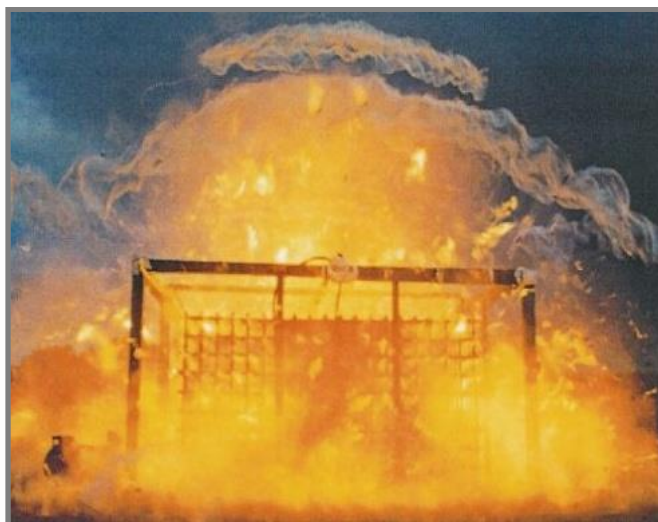
شکل ۳- انفجار ابر بخار در یک محیط متراکم
