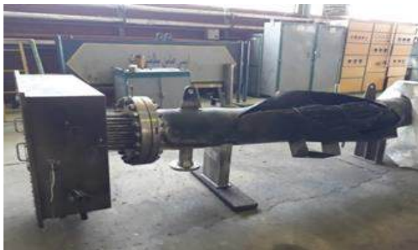
مبدل حرارتی منفجر شده
