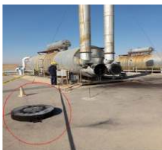
محل افتادن درب هیتر در اثر انفجار
