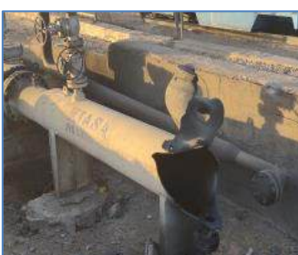
شکل ۲- محفظه ارسال توپک منفجر شده (ایستگاه A)
